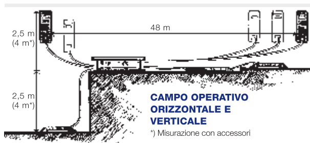
Utilizzo dei tastatori per la livellazione delle casseforme per solai (regolazione della vite ad una mano sola)
